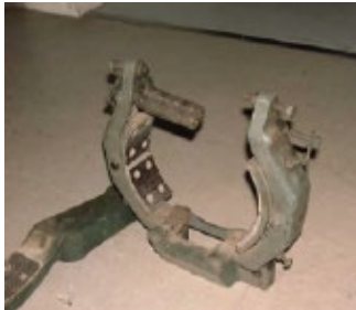
Asbest in remmen - ernstig risico voor de gezondheid indien de remvoering zonder voorzorgen verwijderd wordt.
