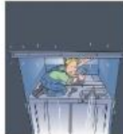
Riziko rozdrčení v horní části šachty, není-li tam dostatečný
